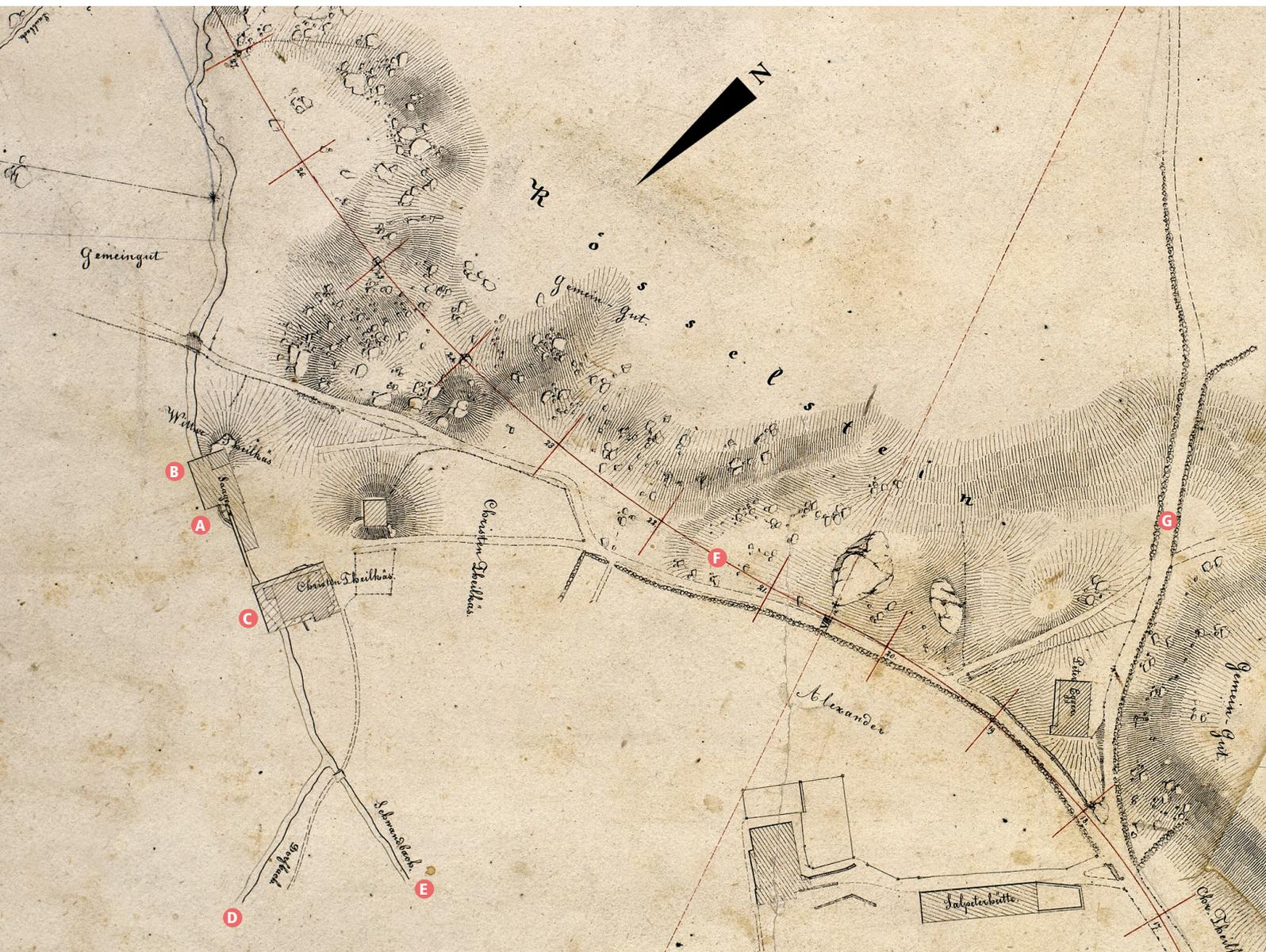
Sägemoos und Rösselsteine auf einem Plan aus dem Jahr 1843. (A) die Saage mit (B) angebauter Behausung; (C) Haus auf dem Stein; (D) Glingenbach und (E) Schwandbach bildeten die Wasserkraft für das Sägewerk. (F) Die rote Linie zeigt die projektierte heutige Staatsstrasse; (G) die alte Strasse nach Reutigen.
