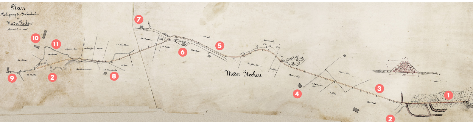
Als Folge der Katastrophe vom Juni 1849 wurde im Jahr 1850 eine «Verlegung des Stockenbaches» geplant (rot eingezeichnet). An der Stelle des heutigen unteren Weihers waren Schutzwälle vorgesehen. Dieses Projekt gelangte nie zur Ausführung. Zur besseren Orientierung folgende nummerierte Objekte:
